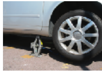
フラットな地面上でジャッキアップはしてください
